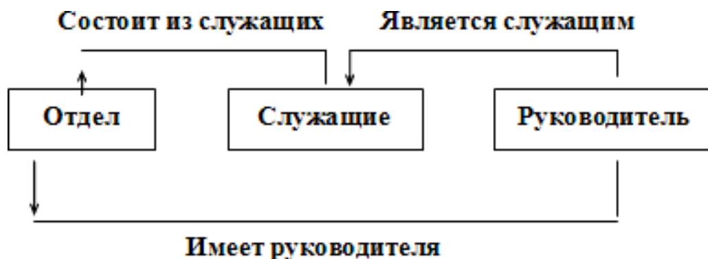
Рис. 2.3. Пример схемы сетевой базы данных
