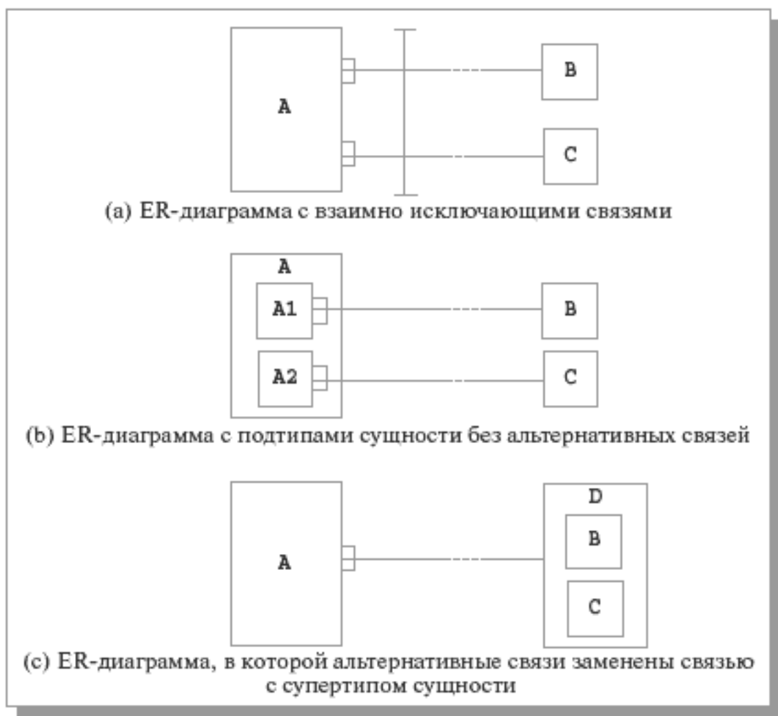
Рис. 10.14. Возможные модификации ER-диаграмм, позволяющие избежать взаимно исключающих связей
